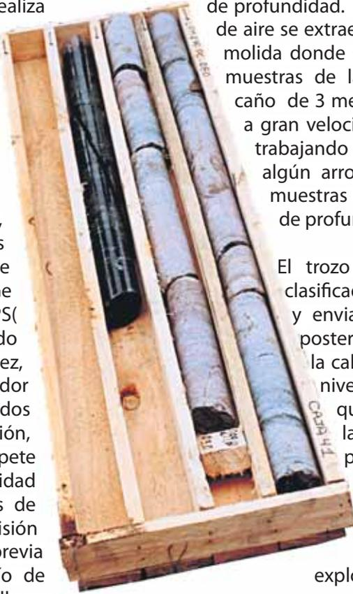
Detectada la zona con la guía técnica de los geólogos, se abre un hoyo del diámetro de un caño de 110", inclinado y de 150 metros de profundidad. Por un sistema de presión de aire se extraen las muestras de la tierra molida donde se analizará; para obtener muestras de la roca se introduce un caño de 3 metros de largo que girando a gran velocidad perfora en la misma trabajando con agua que se extrae de algún arroyo o cañada. Se extraen muestras de hasta casi 300 metros de profundidad.
